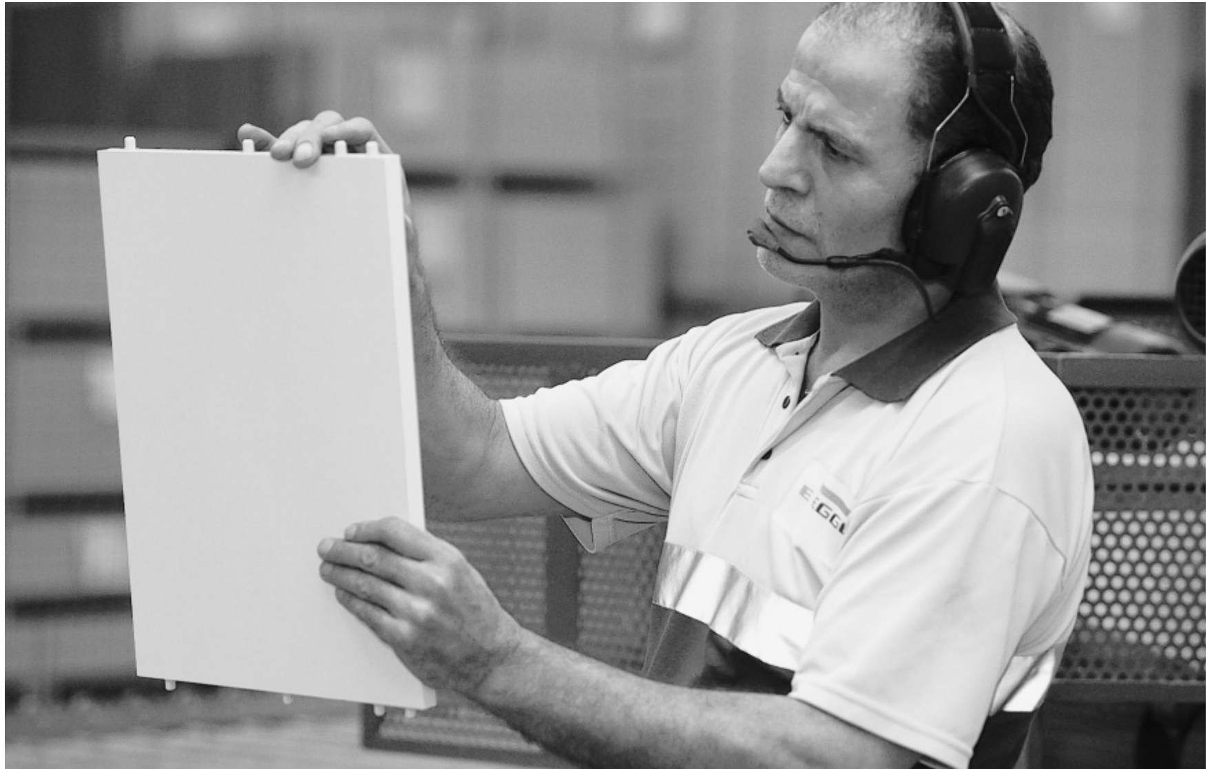
Qualitätssicherung: Mehmet Avsar kontrolliert Kanten und Dübel.
