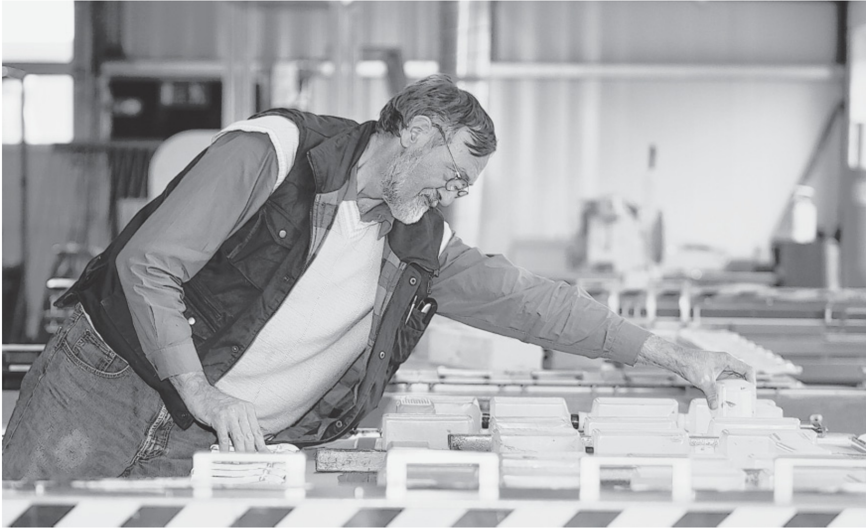
Genauigkeit gefragt: Hartmut Eickmeyer, der Onkel des Geschäftsführers, legt Gewichte auf frisch geklebte Schablonen für den Siebdruck
