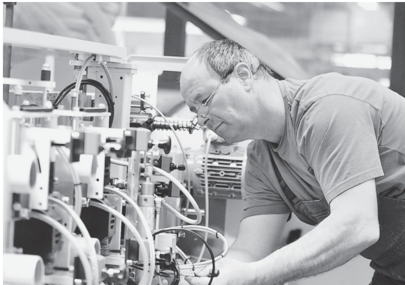
Feinarbeit: Oleg Steinwand justiert den Eckenfräser an einer in Produktion befindlichen Kantenanleimmaschine.
