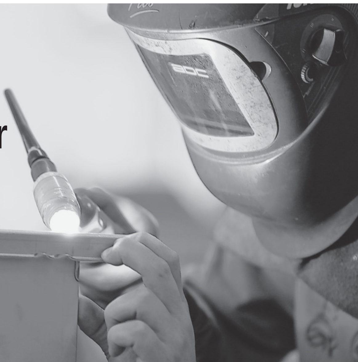
Sorgfalt gefragt: Metallbauer Tom Unversucht beim Schweißen von Details an einer neuen gewerblichen Großküche.
