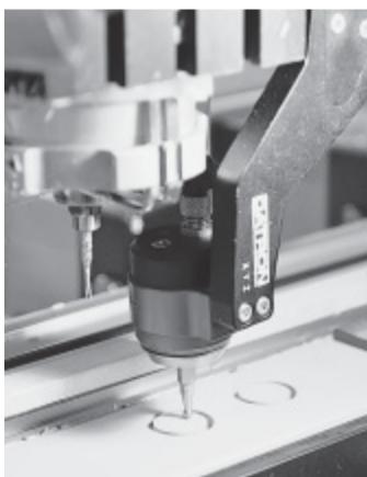
Individuell: Im hauseigenen Bearbeitungszentrum werden die Gehäuse gefertigt.
