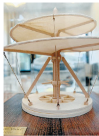
Ungewöhnliches Flugobjekt: Zwischen 1480 und 1490 entwarf Leonardo diese Luftschraube.
